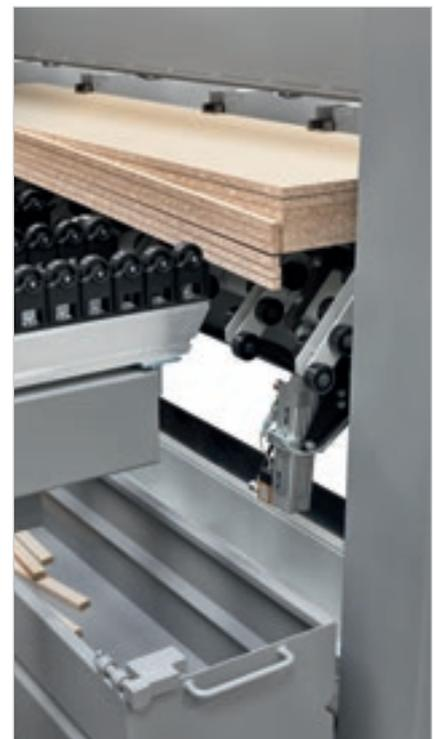
Los recortes longitudinales se evacúan a través de una trampilla totalmente automática compuesta por ruedas libres.
