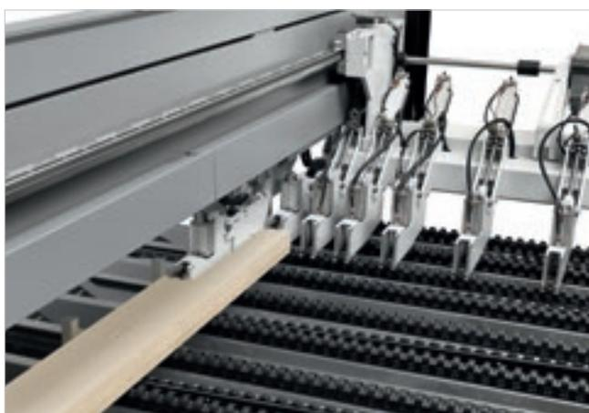
Sistema para la ejecución contemporánea de cortes transversales diferenciados compuesta por dos pulsadores, completamente desvinculados entre ellos y una pinza loca (sin motor), totalmente independiente.
